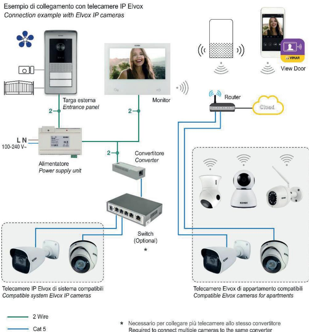
Figura 1 - Esempio di schema di interconnessione tra telecamere TVCC Elvox e sistema IPo2W
