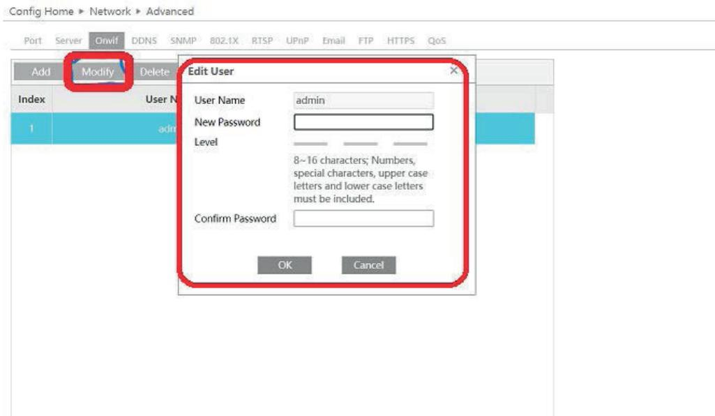
Nella configurazione della telecamera IP cablata nel sistema IPo2W, inserire le credenziali dell'utente Onvif (nome utente e password), anche se differenti da quelle utilizzare per accedere all'interfaccia web di configurazione.
